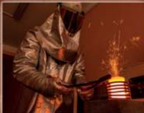
Индукционный нагрев тигля с металлом токами высокой частоты
